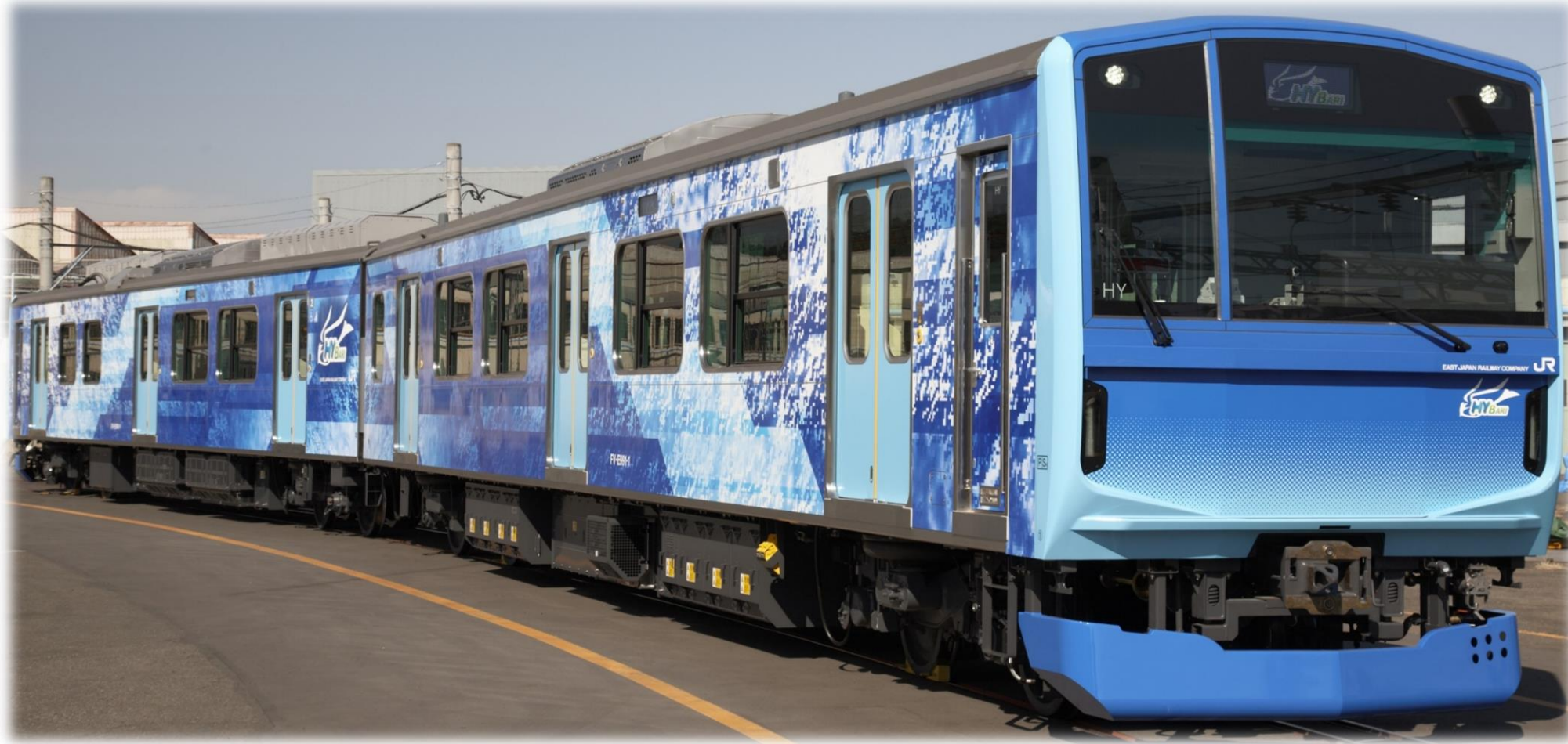
写真:水素ハイブリット電車(HYBARI)
