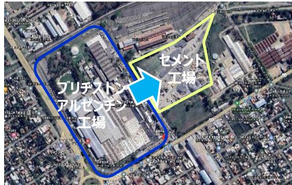
水ストレス地域に位置するアルゼンチン工場では、隣接するセメントメーカーとパートナーシップを結び、工場排水をセメント製造の原材料として再利用することで、地域全体との取水量削減に貢献
