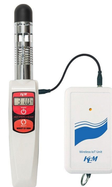
観測に利用したWBGT測定機器 (Sigfox, 簡易型)
