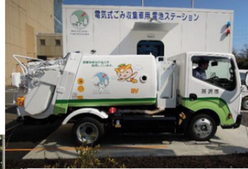
EVパッカー車
