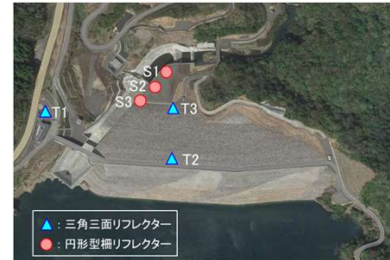
図-1 リフレクター設置箇所および検討項目
