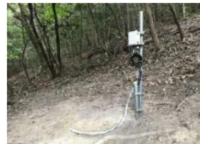
崩壊発生予測の実証 (山地の土壌水分量・水温の観測)
