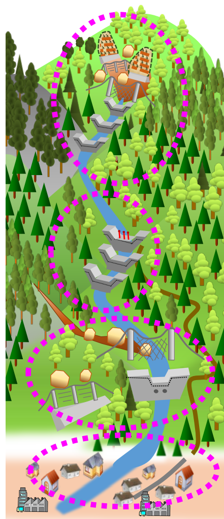
ワイヤーネットやスリットダムによる土石や流木の捕捉
