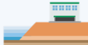
地盤の嵩上げ
