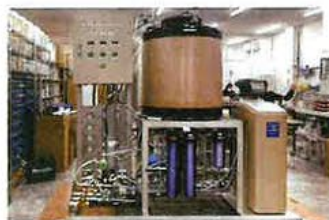
● ODA設備整備としてRO純水装置を20フィートコンテナで搭載 (ケニア・バラボ・セネガルに導入)
