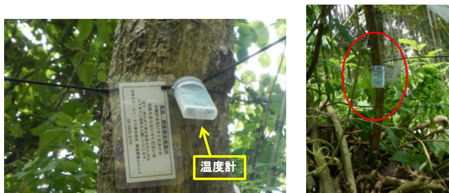
図 5-11 温度計の設置方法（平成 30・31 年度）
