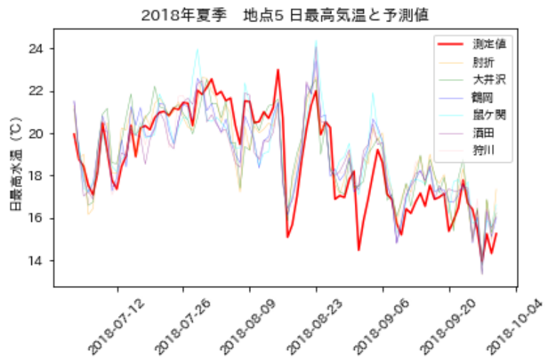
図 5-15(2) 平成 30 年度夏季の各観測地点における日最高水温測定値と五十川近傍のアメダスを用いた予測値の比較（上から地点①から地点⑤）
