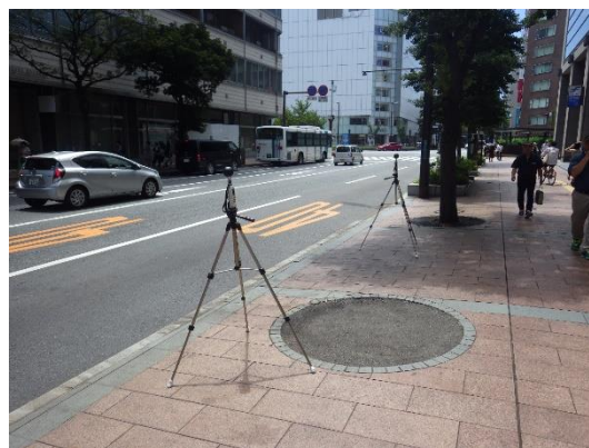
図 4.3-3 暑さ指数計の動作確認状況（左）および現地踏査時の機器設置状況（右）
